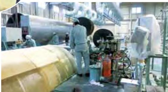
FRP地下タンク製造中
