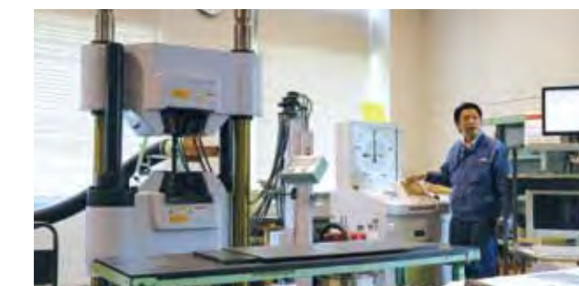
物の強さを調べる引張り試験
